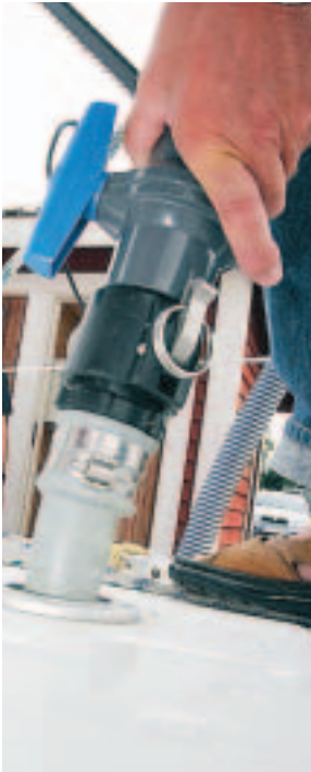
Segelbåtens latrin sugas direkt in i det vanliga avloppssystemet på land.
